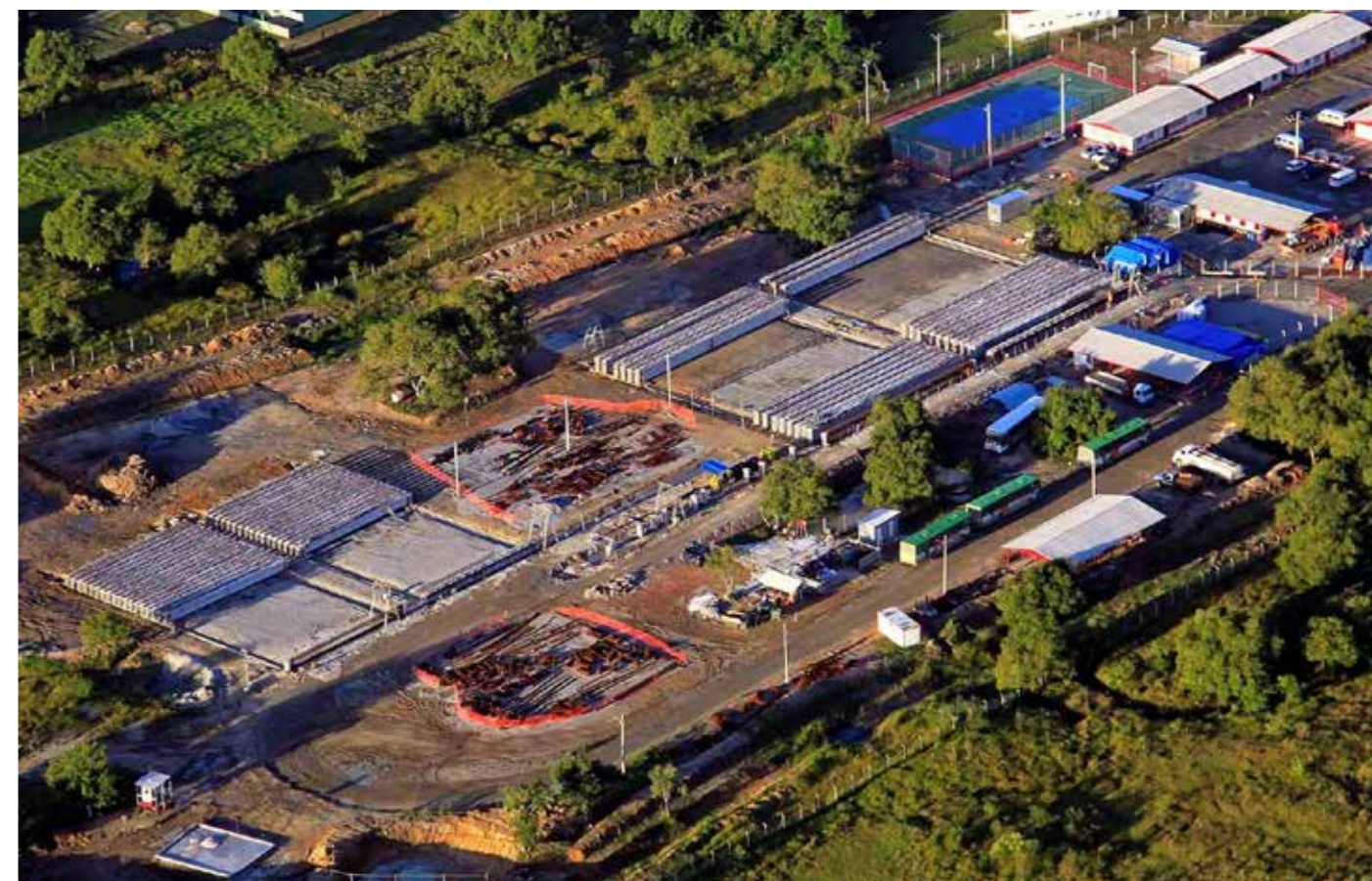
Pátio de fabricação de 160 vigas protendidas para as pontes e viadutos do Arco Metropolitano do Rio de Janeiro
